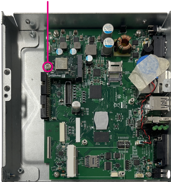
Secure the M.2 Key E Module
